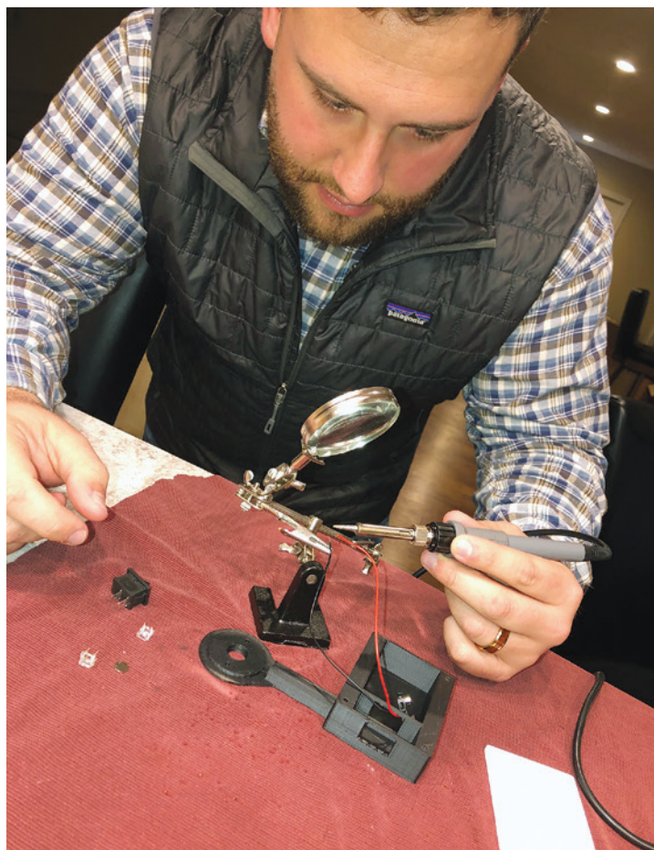
Drew Deathe soude les composants électroniques pour le microscope imprimé sur 3D qui peut être attaché à un téléphone mobile pour évaluer les symptômes du trachome.
